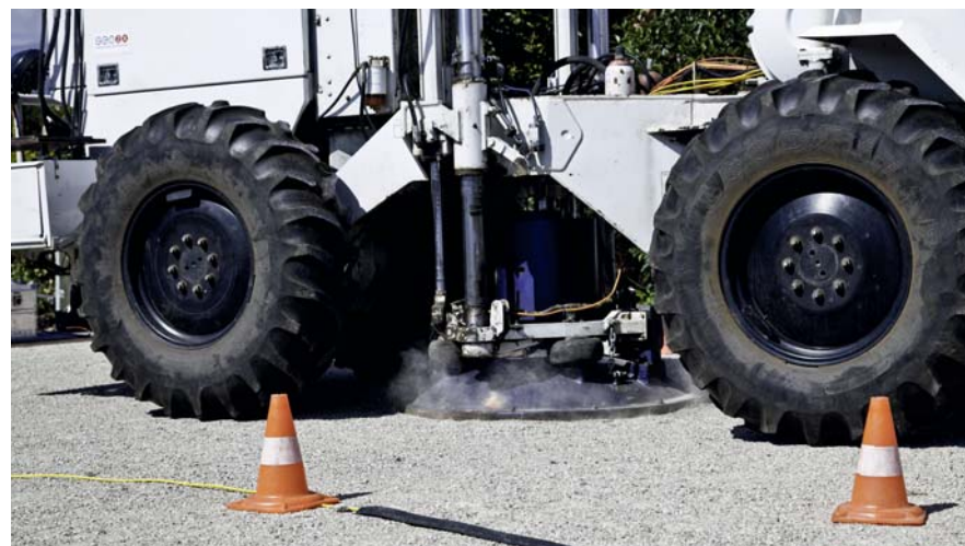
Deux méthodes de prospection sont utilisées dans le cadre du programme GEothermie 2020: la chute de poids et le camion vibreur.
