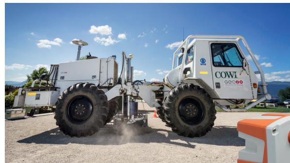
Camion vibreur et capteur «géophone» utilisés lors de la phase de prospection.
